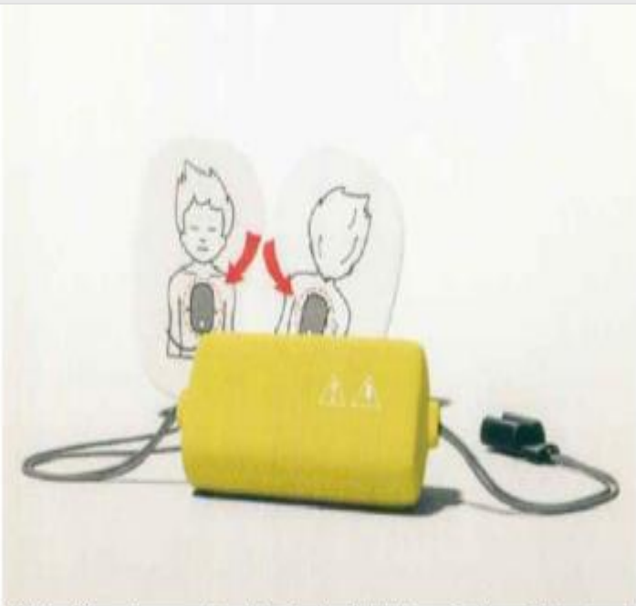
شکل ۳۴. نمونه‌ای از تضعیف‌کننده شوک در اطفال که شوک تخلیه شده توسط دستگاه AED را کاهش می‌دهد. پدهای مخصوص اطفال هم از این تضعیف‌کننده‌ها دارند.
